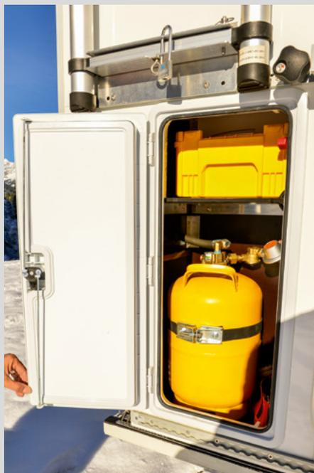
**Tank, die Zweite:** Die Gasflasche kann über einen Außenanschluss betankt werden. Dadurch muss auch sie nicht herausgenommen werden.
