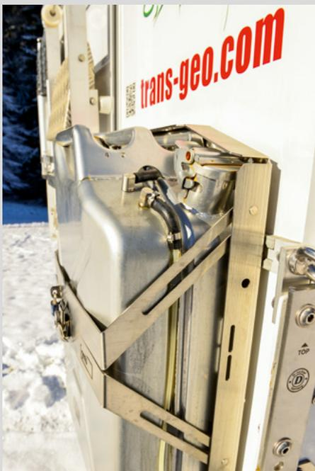
**Tank, die Erste:** Der Edelstahl-Benzinkanister dient als Tank für die Heizung. Zum Befüllen wird er leicht gekippt und kann an Ort und Stelle bleiben.
