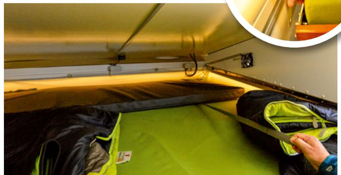
**Geräumiger Schlafplatz:** Das Bett misst 1,60 x 2,15 Meter. Der Auszug wird rechts und links aufgehängt. Zum Einschieben wird das Fußteil angehoben.
