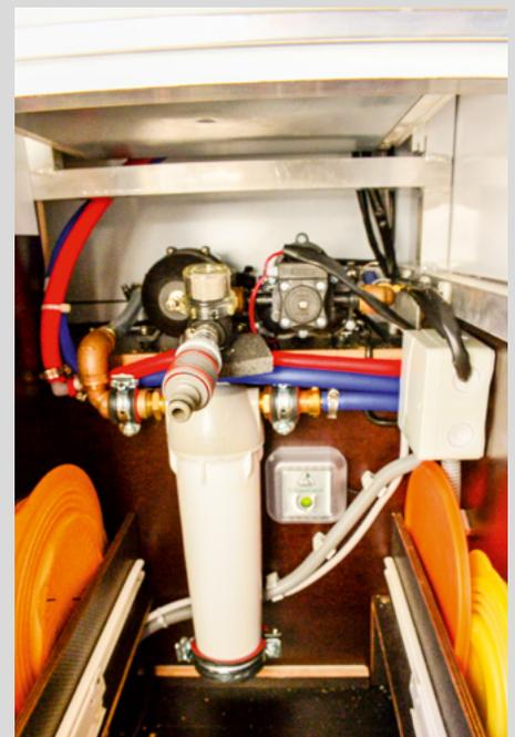
**Tank, die Dritte:** Der Wasserfilter sitzt unter dem Spülbecken. Der Anschluss zum Befüllen des Wassertanks direkt darüber.
